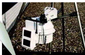
regen meten volgens de richtlijnen ombouwset 7440-WV met beugel om regenmeter op de grond te plaatsen
